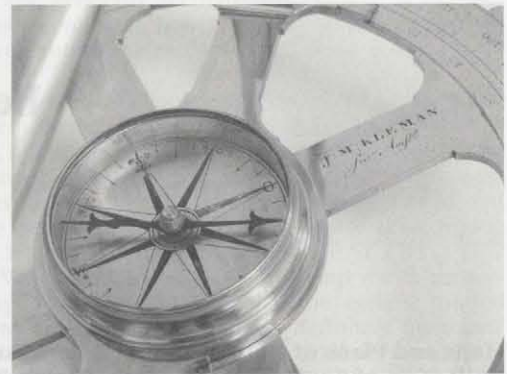
4. Instrument Meetinstrument; Hollandse Cirkel 1785
